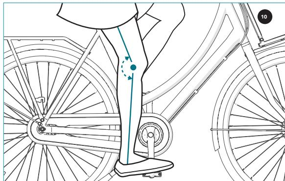
Stellen Sie sicher, dass sich der Sattel auf einer Höhe befindet, bei der Ihre Knie leicht gebeugt sind, wenn das Pedal unten ist (10).
